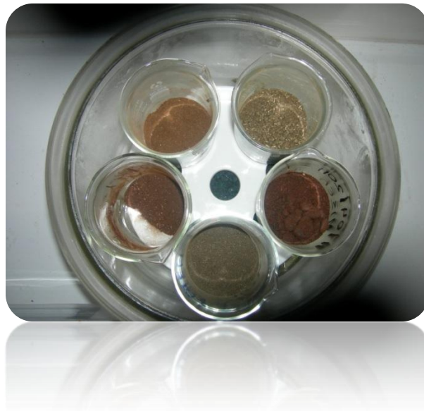
Εικόνα 19: Ομογενοποιημένο υλικό με τη χρήση ανοξείδωτου μύλου άλεσης
