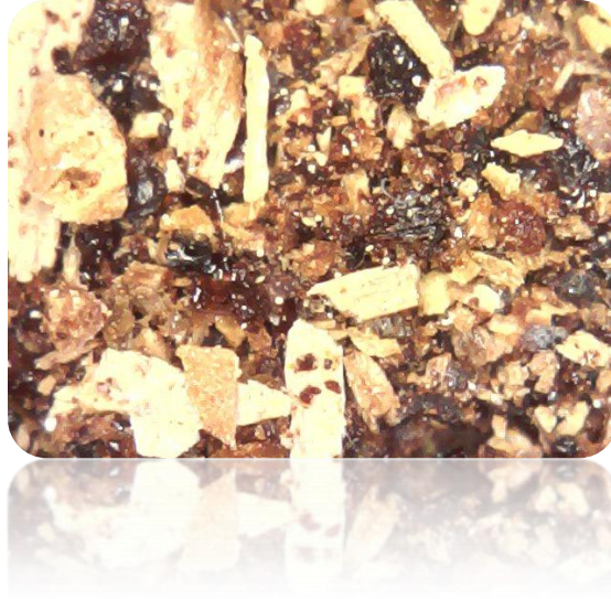
Εικόνα 28: Σκόνη ξηραμένων διατροφικών αποβλήτων με ηλεκτρονικό μικροσκόπιο
