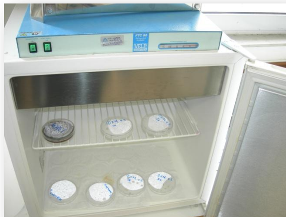
Εικόνα 17: Σπόροι τοποθετημένοι σε συνθήκες σκοταδίου και ελεγχόμενης θερμοκρασίας
