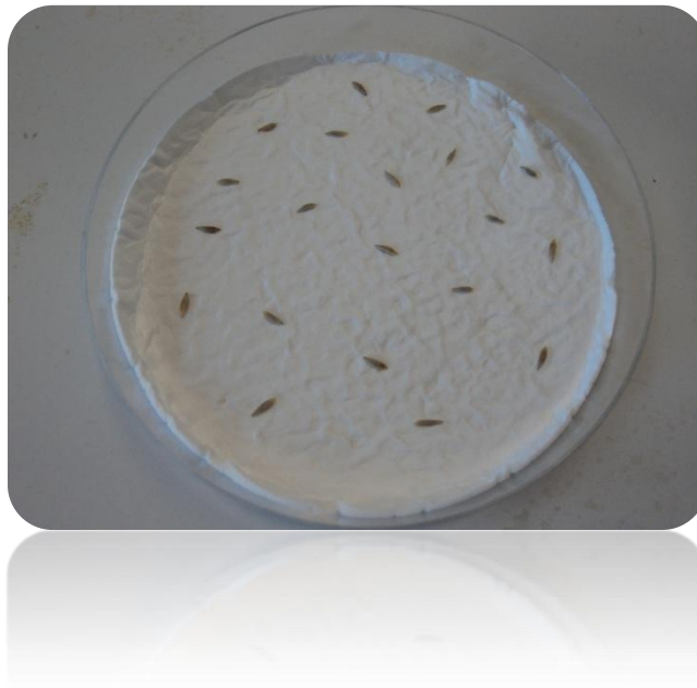
Εικόνα 14: Σπόροι μαρουλιού τοποθετημένοι στο τρυβλίο Petri για τεστ φυτοτοξικότητας
