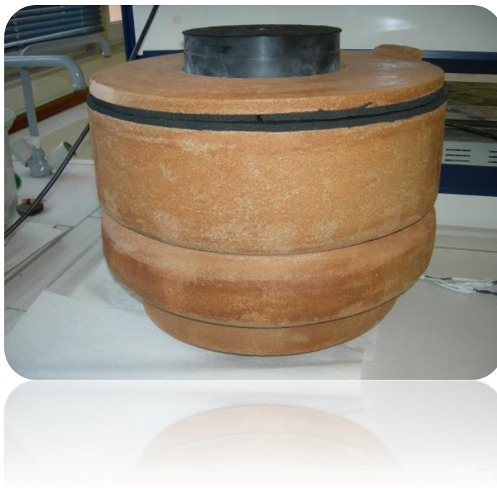
Εικόνα 2: Πρότυπο σύστημα οικιακής ξήρανσης οργανικών απορριμμάτων
